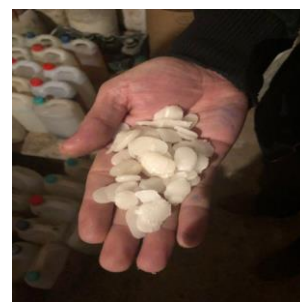
شکل ۳: ماده تغییر فاز دهنده مورد استفاده در آزمایش (پارافین جامد)
